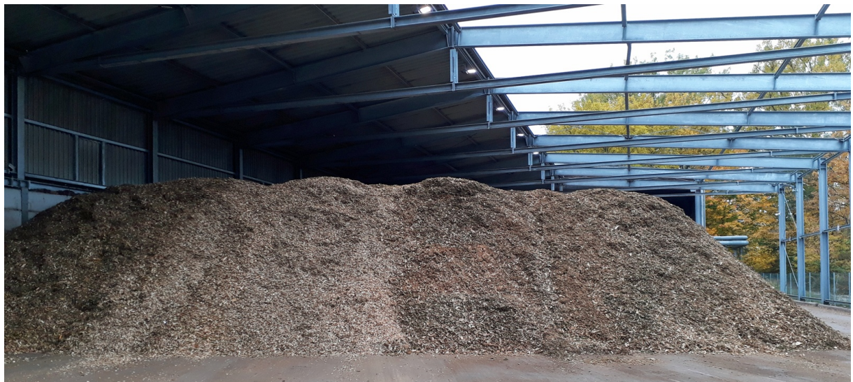
Einige 1000 m 3 Hackschnitzel (= ca. 1 Wochen-Bedarf) warten auf ihre Verfeuerung im BHKW Rosenberg
